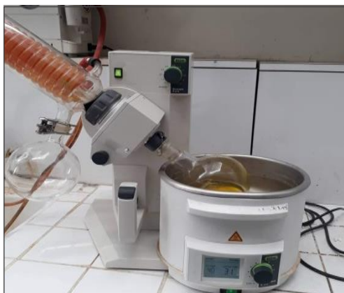
Figure 19: Évaporation du filtrat (Photo originale).
