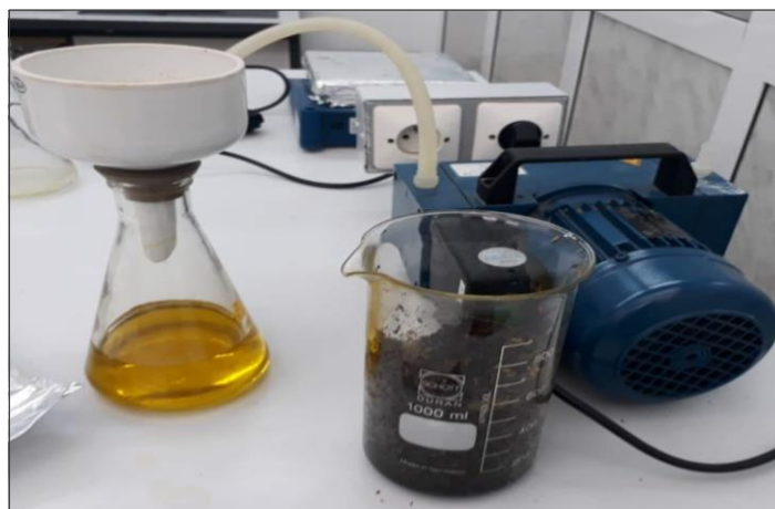
Figure 18 : Filtration de macérât sous vide (Photo originale).
